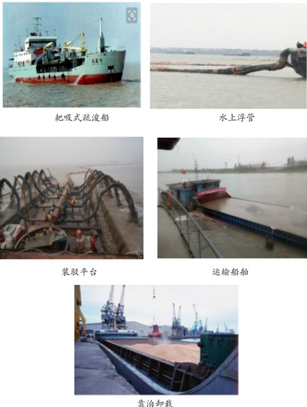
图1 长江下游疏浚砂综合利用总体流程图
