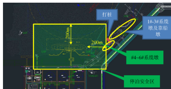
图 4 码头施工与停泊安全区关系图
