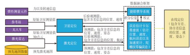
图 4 定位算法实施框图
