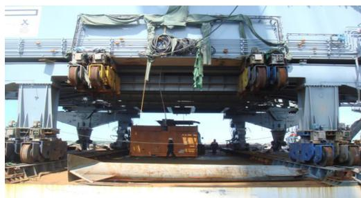
图6 陆侧结构设计成分段可拆形式
