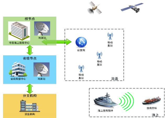
图1 基于移动定位的海上搜救辅助系统方案框架
