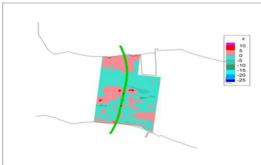
图5 桥区河段平面冲淤分布图(2006年~2010年)
