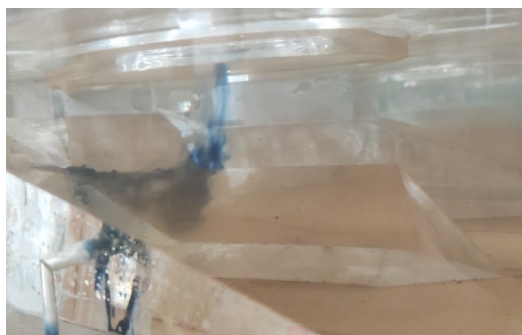
图4 S1工况下泵舱C后壁的流动状态
