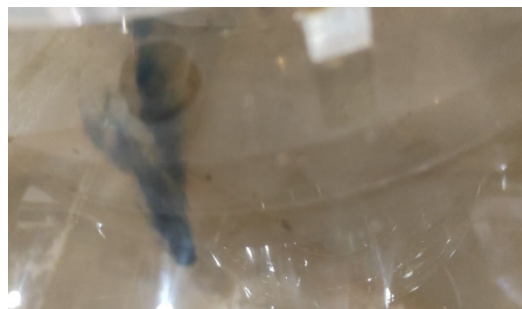
图5 S11工况下泵舱B右侧侧壁的流动状态
