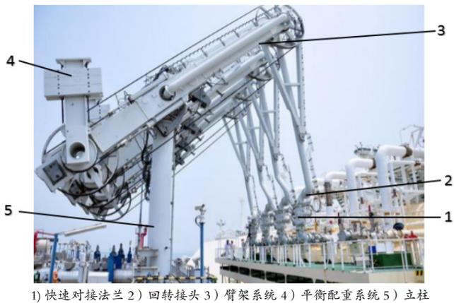
图1 刚性输送臂基本结构图
