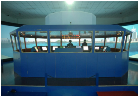
图9 试验用船舶操纵模拟器
