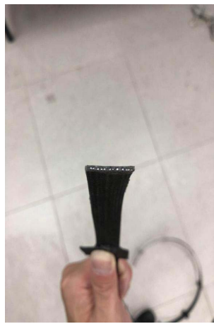
图 2 钢塑土工格栅断面
