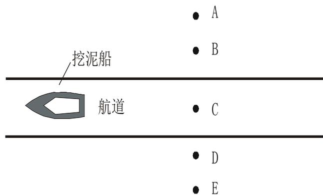
图 1 含沙量观测点布置图
