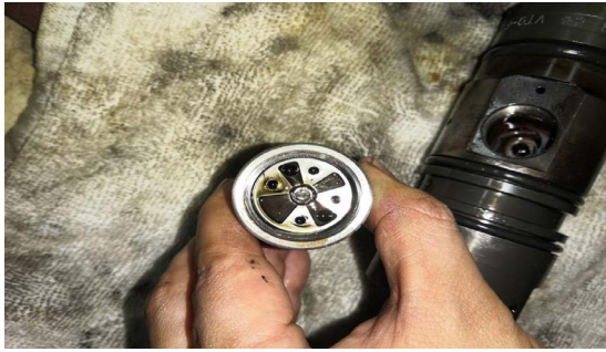
图1 油嘴针阀断裂
