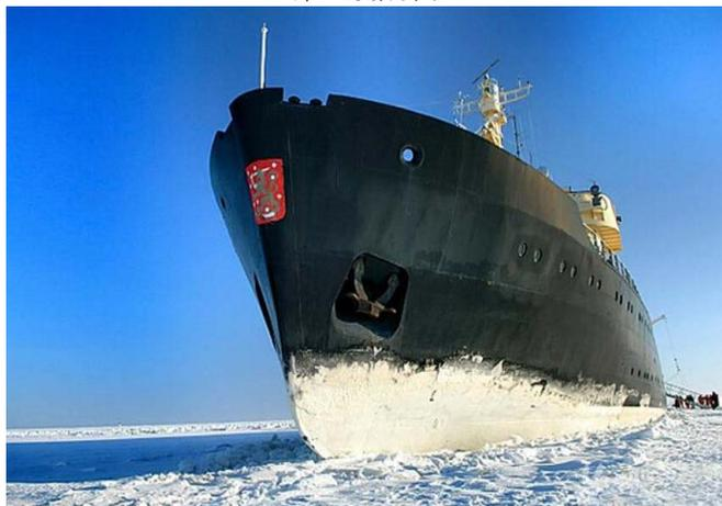
图2 冲撞破冰船
