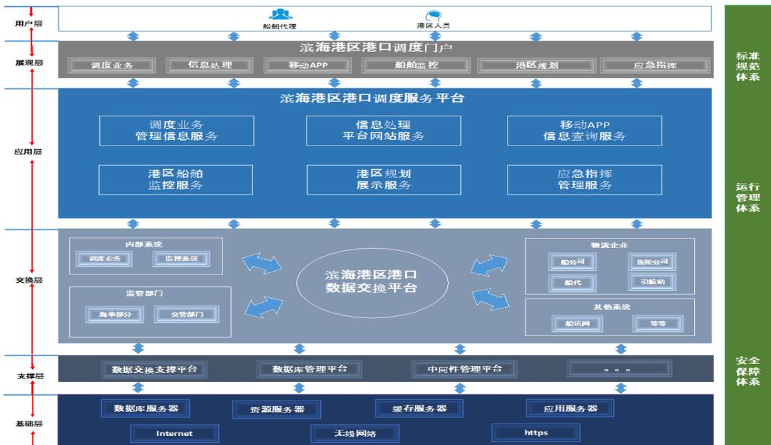
图 2 系统架构图
