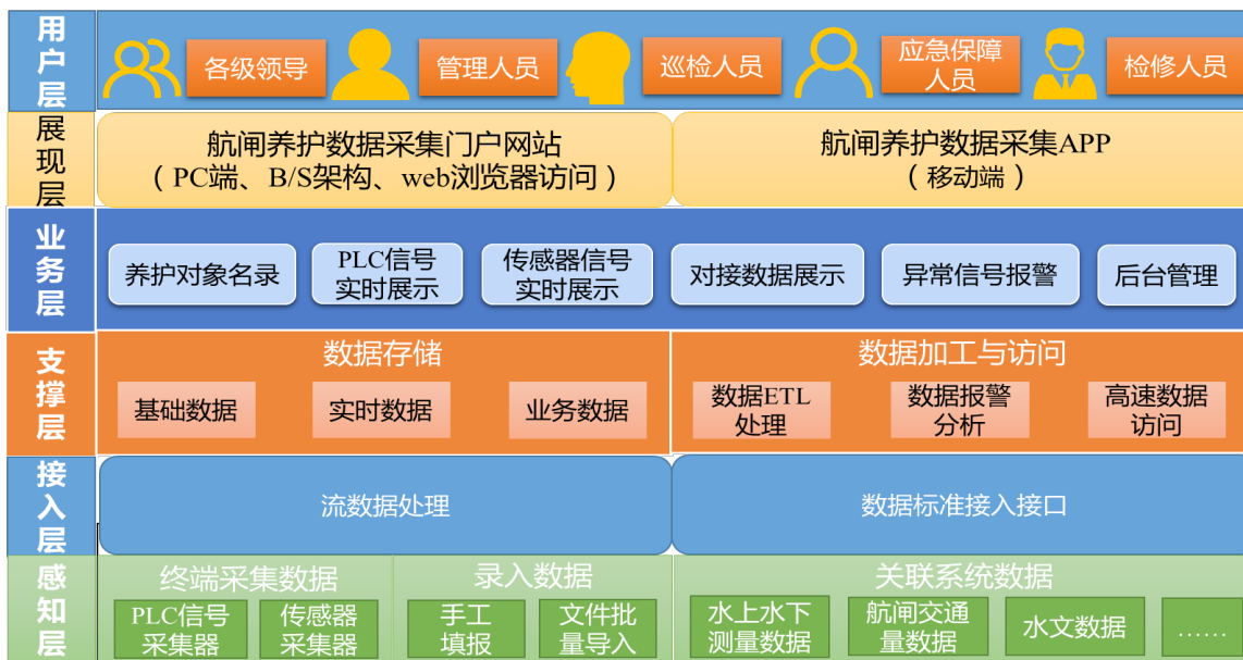
图 1 航闸养护数据采集系统总体架构
