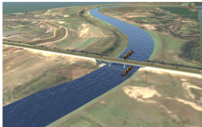
图2 运用BIM研究船舶航行条件
