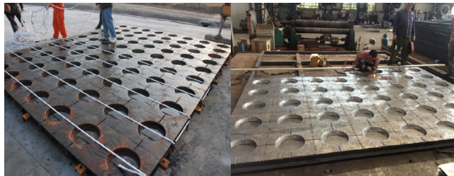
图3 新型混凝土的D型联锁块预制模板
